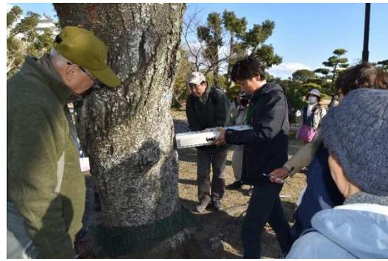
レジストグラフの見方解説(抵抗がないところが腐朽) ジストグラフの実演(見えない幹中の腐朽度が分かる)
